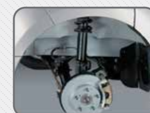
Hệ thống giảm xóc trước MacPherson nhẹ và chắc chắn, đặc biệt an toàn khi phanh gấp
